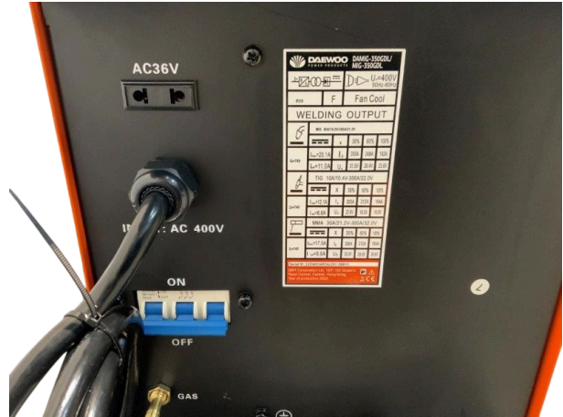
Rückseite: Netzkabel 400 V, Netzschalter (ON/OFF), Gasanschluss und 36-V-Steckdose
