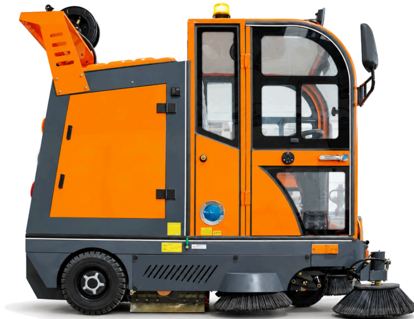
Seitenansicht – vier Seitenbürsten und Hauptkehrwalze
