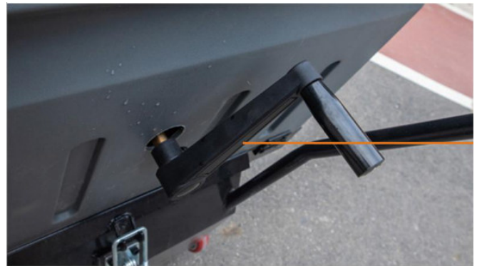
4 – Rüttelhebel für die Filterabreinigung
