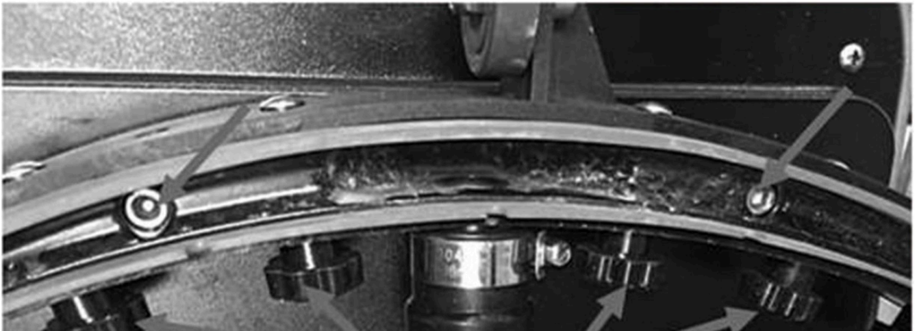
Die 8 Kunststoffmuttern auf der Rückseite des Saugbalkens
